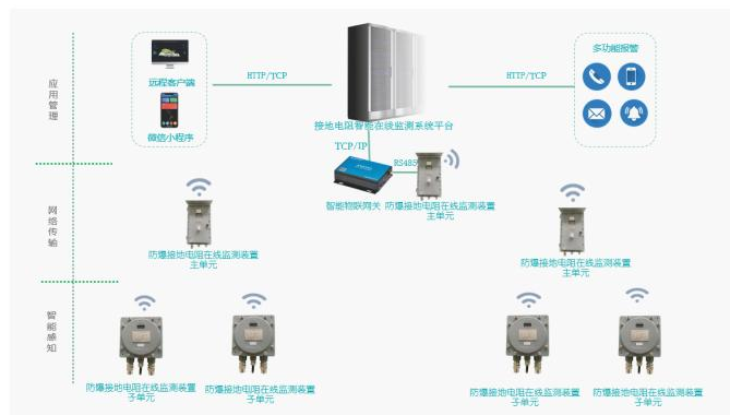
中石化海南炼化接地电阻智能在线监测系统
