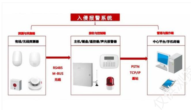
中石油海南销售库站监控系统及一键报警系统
