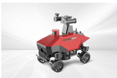
厂站机器人巡检
